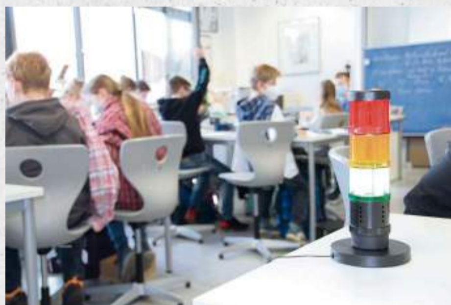
Die CO 2 -Ampel misst den aktuellen CO 2 -Gehalt in der Raumluft und signalisiert – gemäß Bundesumweltamt – eindeutig und klar in drei Farben, wann ein Lüften notwendig wird, z. B. im Büro, Klassenzimmer, Besprechungszimmer oder öffentlichen Gebäuden.
