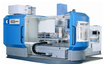
Auerbach RX 3 TLF – 5-Achs CNC Tieflochbohrmaschine Steuerung: Heidenhain TNC 640 | Verfahrwege: X 1.800 / Y 1.200 / Z 700 Werkzeugspeicher: 24 Plätze Bohrtiefe: 1.200 mm von einer Seite Tischbelastung: 7 Tönnen Sonderausstattung: Gesteuerter Drehtisch (B-Rhse)
